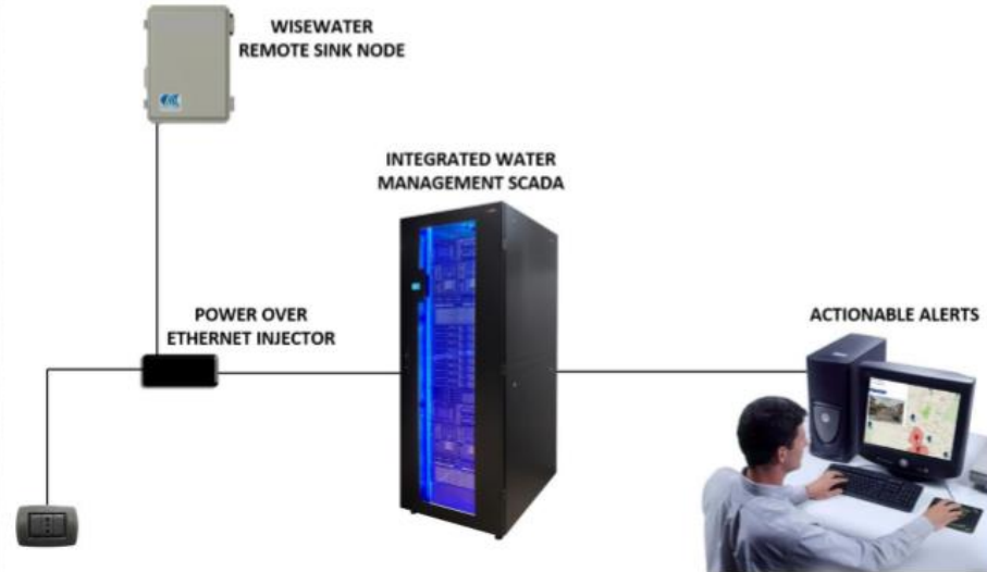
NODO REMOTO INSTALLATO PRESSO CONTROL ROOM
