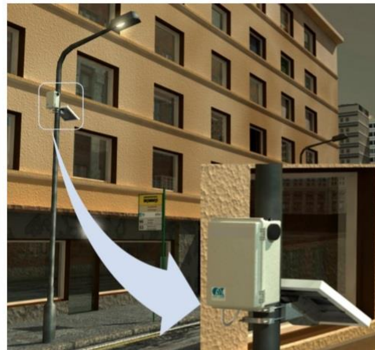
NODO COLLETTORE LOCALE INSTALLATO SU PALO ILLUMINAZIONE
