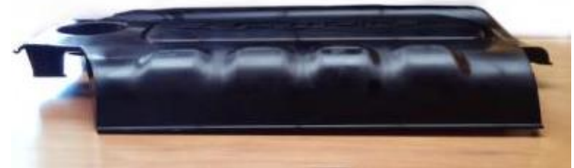
NANOCOMPOSITE PA : warpage 1mm
