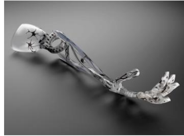
Protesi realizzata tramite tecniche SLS.
