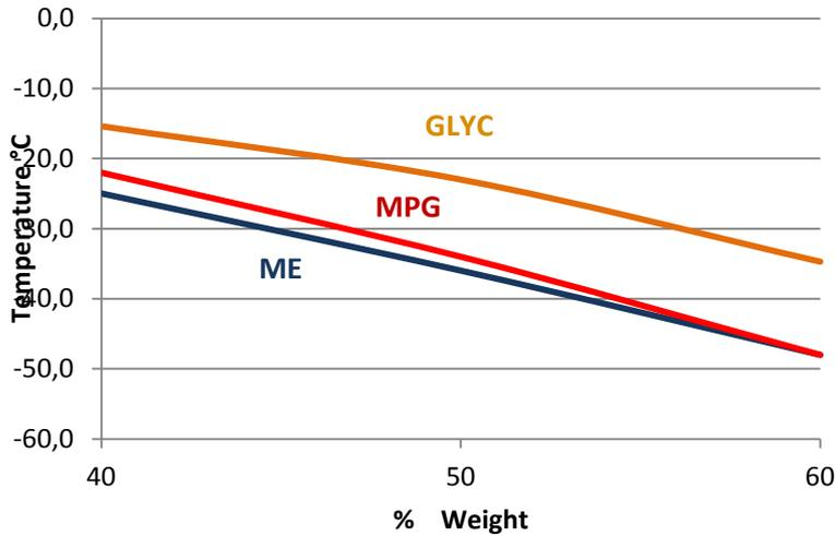
Il glicerolo possiede caratteristiche peggiorative in termini di viscosità e freezing point
